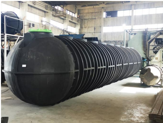
Фото 1. Пример временного размещения резервуара перед установкой на единую ЖБ плиту.
